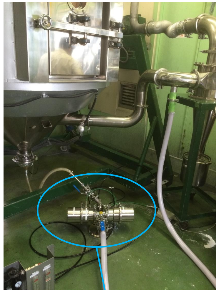
スプレードライヤー乾燥室下とりアルタイム粒度分布測定器Insitexを接続する。
